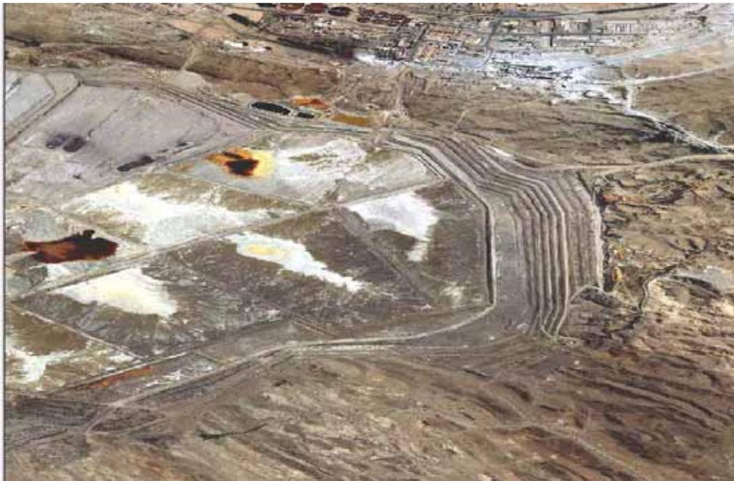
**Abbildung 6-34: Lagerung der Erzaufbereitungsrückstände („Tailings“) bei der Rössing-Mine [Lawson 2008]**
