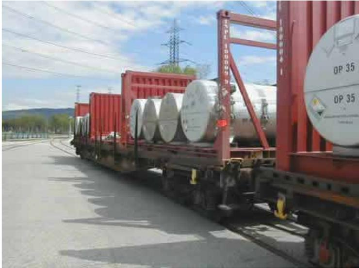
Abbildung 6-5: Behälter für Lagerung und Transport von  $UF_6$  [Kimble 2006]
