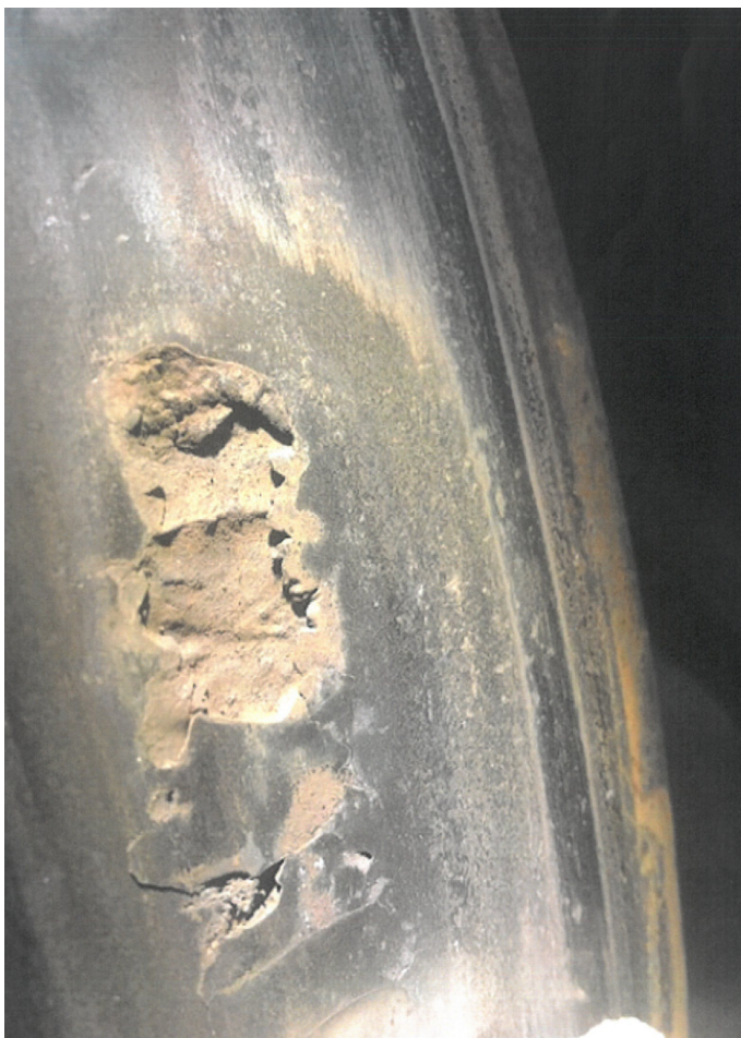
Abbildung 11: Ausbröckelungen auf der Lauffläche
