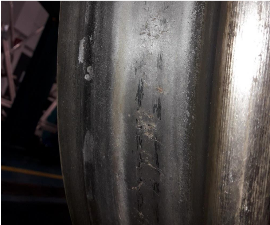
Abbildung 12: Linienförmige Eindrückungen auf der Lauffläche
