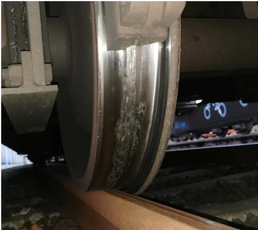
Abbildung 10: Materialauftragung auf einem Rad
