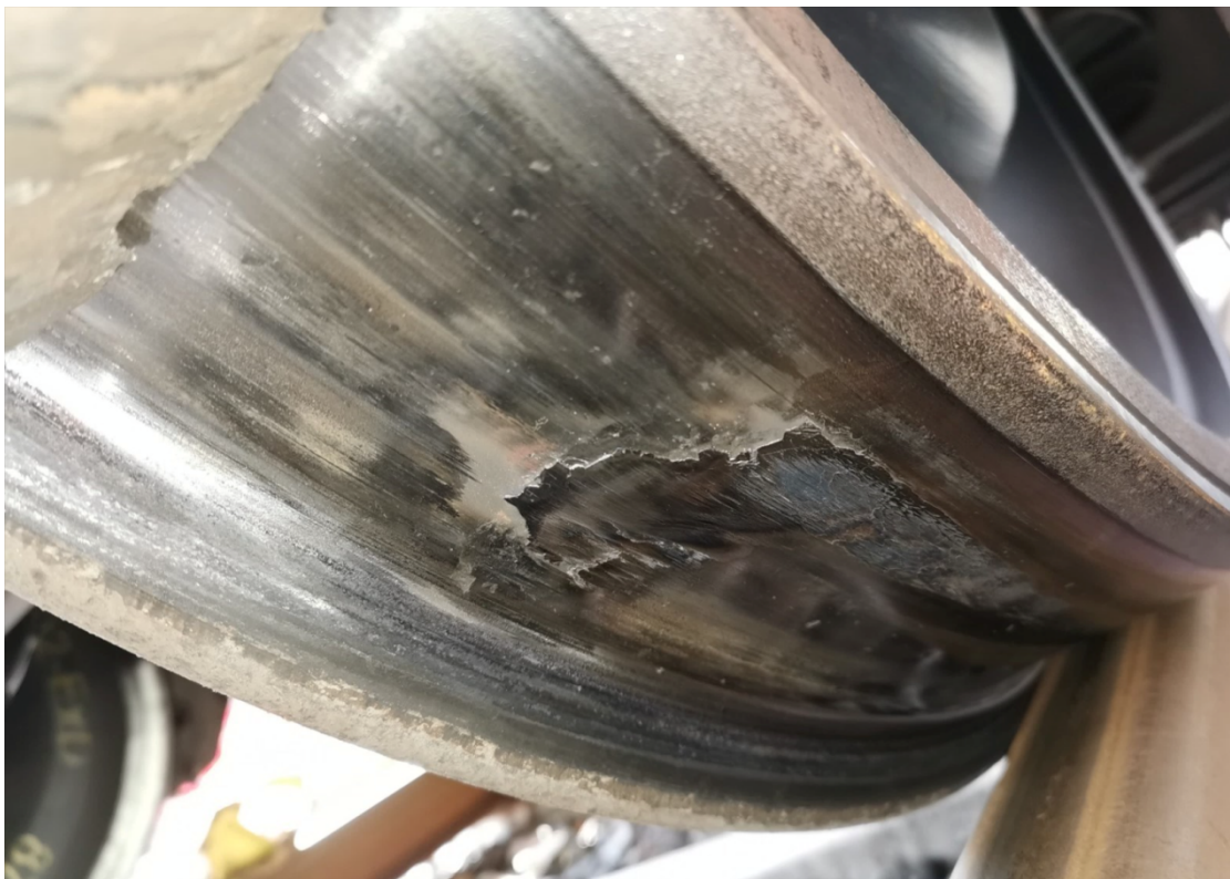
Abbildung 9: Abbildung einer Flachstelle
