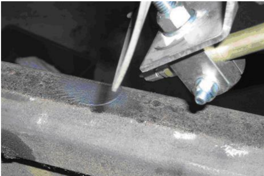
Abbildung 68: Schmierung der Schienenfahrflächen vom Fahrzeug aus
