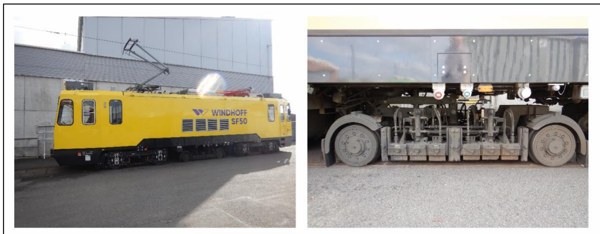
Abbildung 45: Schienenschleifzug mit Rutschersteinen
