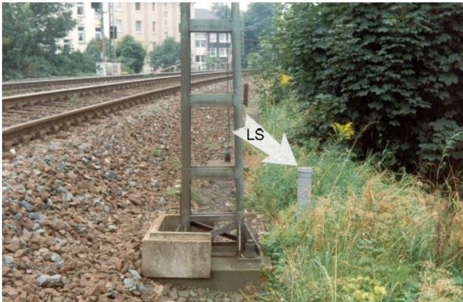
Abbildung 24: Mikrofonstandort für die Langzeitmessung in einem Messquerschnitt an einer Eisenbahnstrecke
