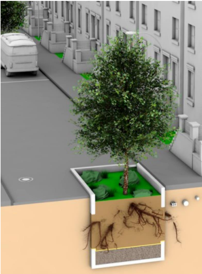
Abbildung 5: Prinzipquerschnitt einer Baum-Rigole
