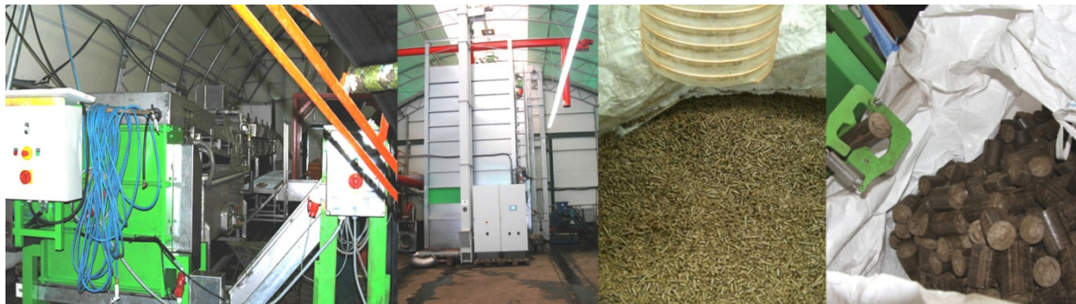
Abbildung 3: florafuel-Verfahren – Fotos von der Anlage in Putzbrunn und den Produkten Pellets und Briketts
