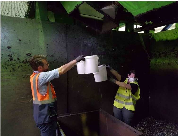
Abbildung 51: Probenahme Kunststofffraktion Drucker < 25 mm Korngröße
