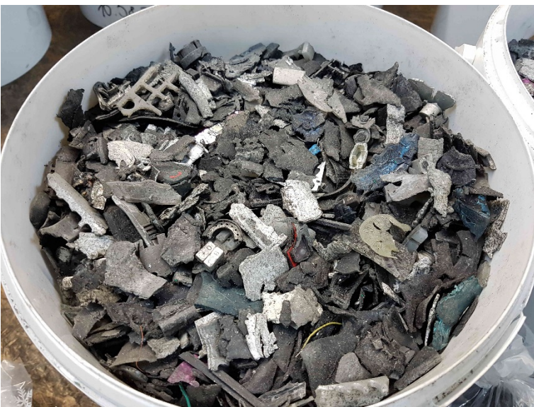
Abbildung 75: Laborprobe Kunststofffraktion aus Telefonen < 25 mm Korngröße
