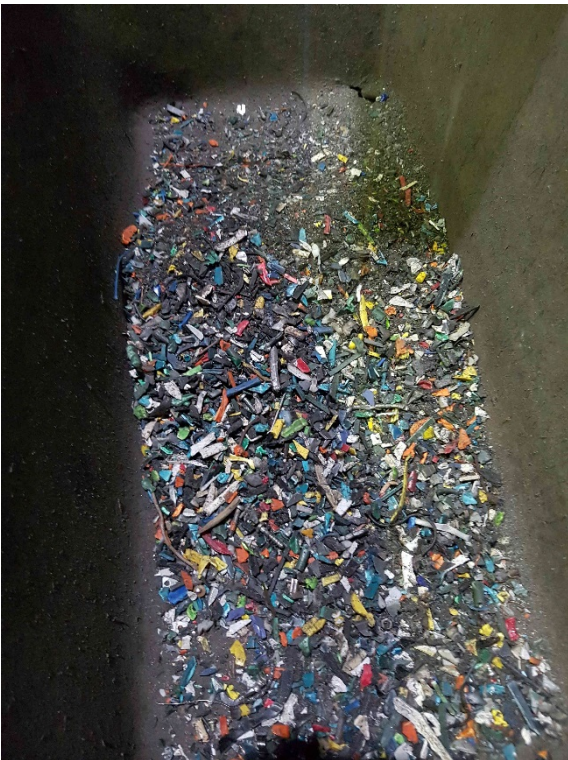
Abbildung 58: Siebfraktion aus Werkzeugen nach Granulator mit 0-10 mm Korngröße
