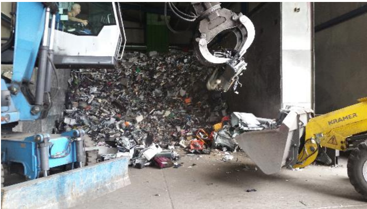
Abbildung 46: Separation von Druckern mit dem Bagger
