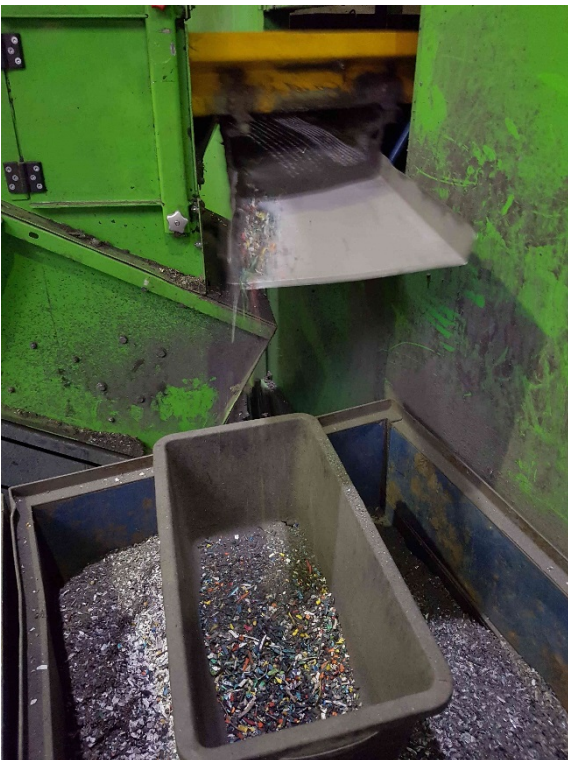
Abbildung 57: Siebfraktion aus Werkzeugen nach Granulator mit 0-10 mm Korngröße
