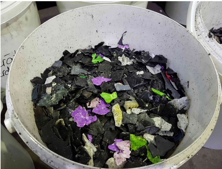
Abbildung 86: Laborprobe Kunststofffraktion aus Unterhaltungselektronik < 25 mm Korngröße
