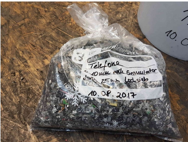
Abbildung 73: Probe der Siebfraktion aus Telefonen nach Granulator mit 0-10 mm Korngröße
