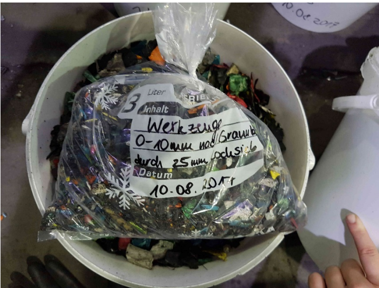
Abbildung 59: Probe der Siebfraktion aus Werkzeugen nach Granulator mit 0-10 mm Korngröße
