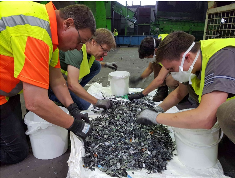
Abbildung 74: Nachsortierung Kunststofffraktion aus Telefonen < 25 mm Korngröße
