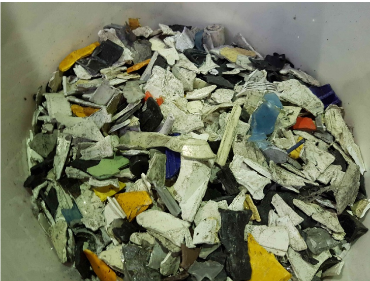
Abbildung 69: Laborprobe Kunststofffraktion aus HHKG < 25 mm Korngröße
