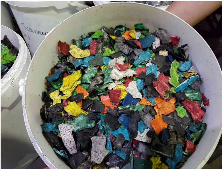
Abbildung 60: Laborprobe Kunststofffraktion aus Werkzeuge < 25 mm Korngröße
