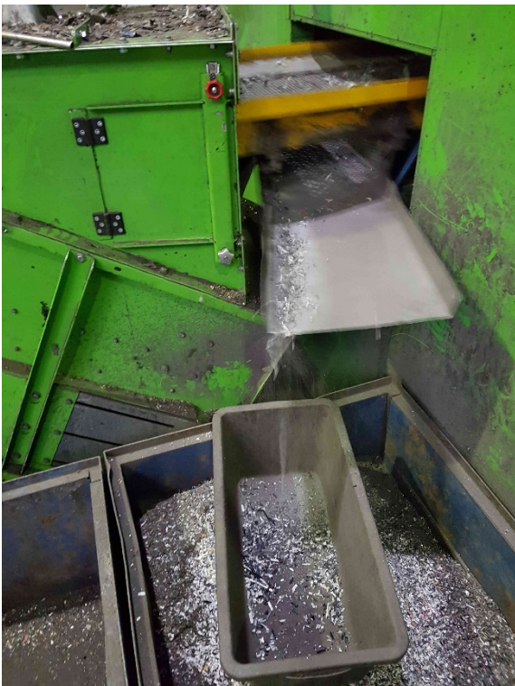
Abbildung 49: Siebfraktion Drucker nach Granulator mit 0-10 mm Korngröße
