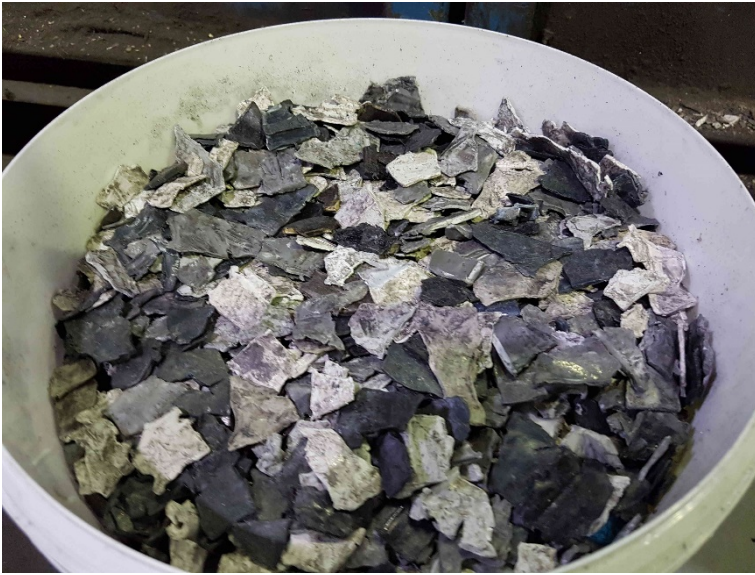
Abbildung 52: Laborprobe Kunststofffraktion Drucker < 25 mm Korngröße
