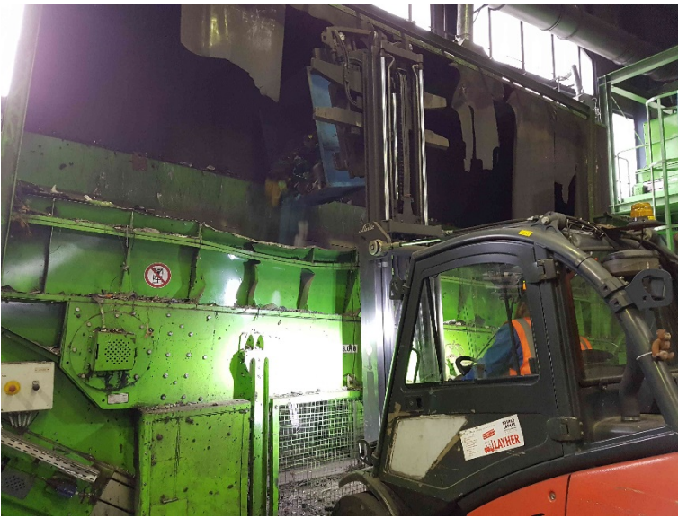
Abbildung 56: Aufgabe Kunststofffraktion aus Werkzeugen in Granulator
