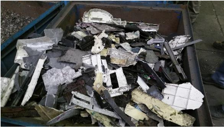
Abbildung 48: Kunststofffraktion Drucker nach QZ
