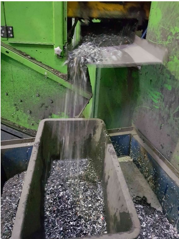
Abbildung 72: Siebfraktion aus Telefonen nach Granulator mit 0-10 mm Korngröße
