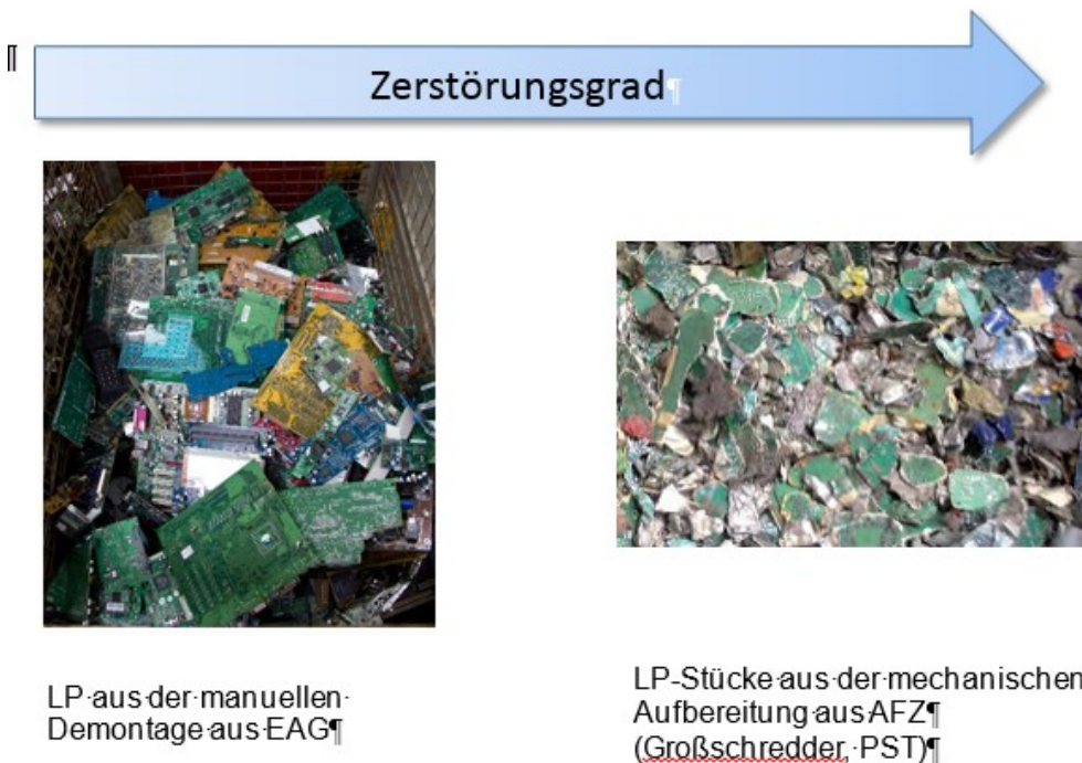
Abbildung 6: Beispiele von Leiterplatten mit unterschiedlichen Zerstörungsgraden
