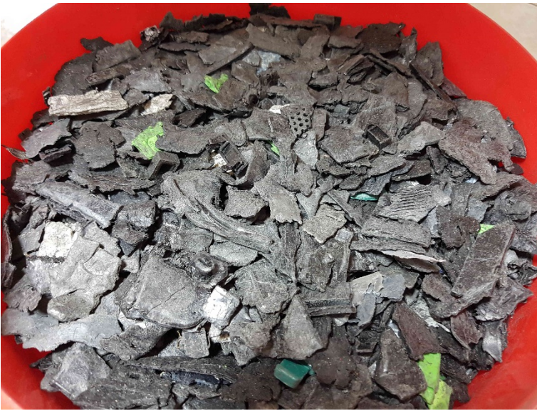
Abbildung 78: Laborprobe Kunststofffraktion aus Computern < 25 mm Korngröße
