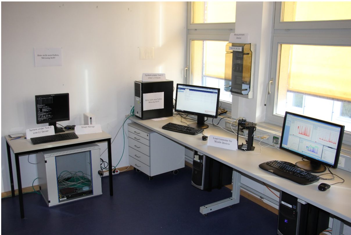
Abbildung 10: Labor für Umwelt- und Nachhaltigkeitsinformatik mit SUT (Client), SUT (Server), Datenerfassungsstation und Janitza-Leistungsmessgerät
