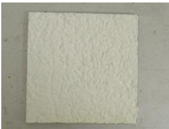
Abbildung 50: die 4 Parallelen der Variante 11 (Dispersionssilikatputz mit Dispersions-Silikatfarbe) zum Ende der Versuchslaufzeit
