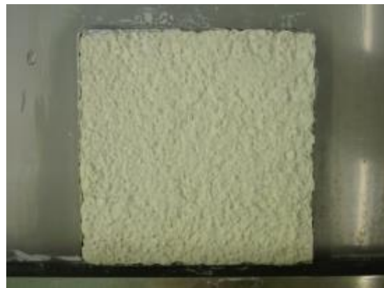
Abbildung 44: die 4 Parallelen der Variante 8 (mineralischer Putz mit silikatischer Fassadenfarbe auf Kaliwasserglasbasis) zum Ende der Versuchslaufzeit
