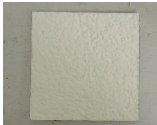
Abbildung 50: die 4 Parallelen der Variante 11 (Dispersionssilikatputz mit Dispersions-Silikatfarbe) zum Ende der Versuchslaufzeit
