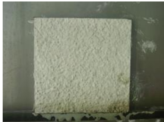
Abbildung 32: die 4 Parallelen der Variante 2 (Silikonharzputz mit Kieselol-Silikatfarbe) zum Ende der Versuchslaufzeit
