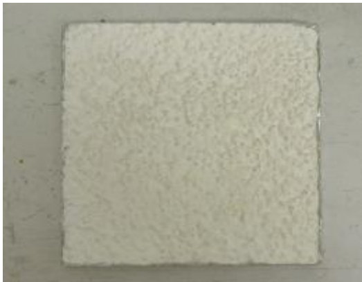
Abbildung 46: die 4 Parallelen der Variante 9 (Dispersions-Silikatputz ohne Anstrich) zum Ende der Versuchslaufzeit
