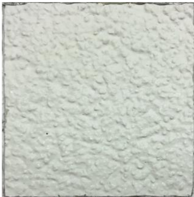
Abbildung 77: Ansicht der Variante 14 nach 6 Stunden Betauungsdauer.
