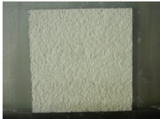
Abbildung 34: die 4 Parallelen der Variante 3 (Silikonharzputz mit ultrahydrophober Farbe) zum Ende der Versuchslaufzeit
