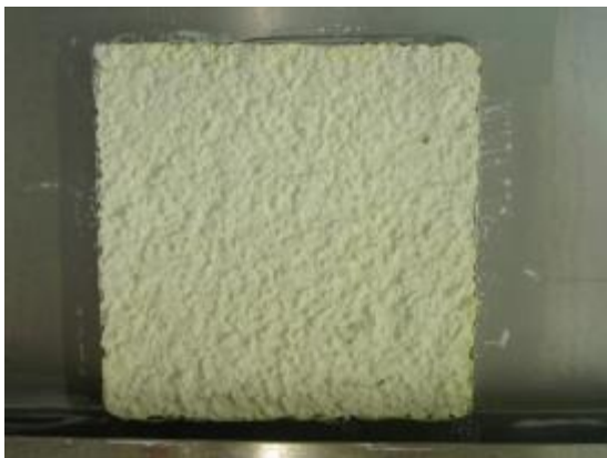
Abbildung 44: die 4 Parallelen der Variante 8 (mineralischer Putz mit silikatischer Fassadenfarbe auf Kaliwasserglasbasis) zum Ende der Versuchslaufzeit
