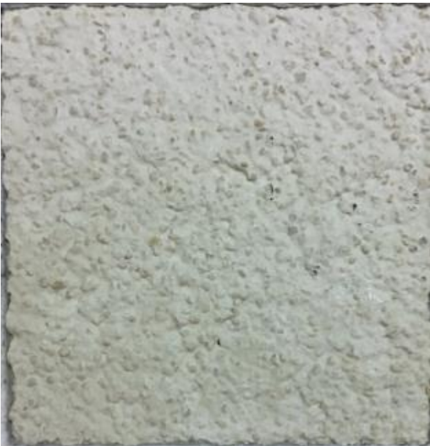
Abbildung 68: Ansicht der Variante 5 nach 6 Stunden Betauungsdauer.
