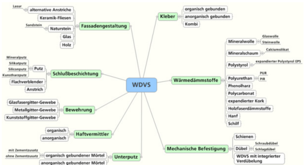
Abbildung 11: Übliche Kombinationen von WDVS-Komponenten
