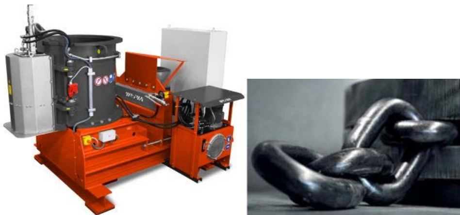
Abbildung 60: Außen- und Innenansicht Querstromzerspaner
