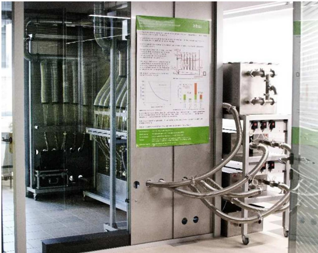
Abbildung 6: CLIMPAQ-Emissionskammer
