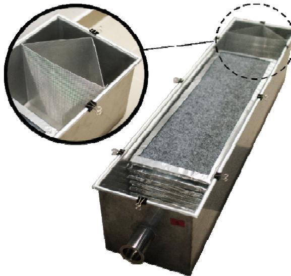
Als Träger für viskose Materialien (wie Putze, Klebstoffe, Farben) werden Glasplatten mit der Abmessung 20 cm x 65 cm verwendet. Feste Materialien (wie Plattenwerkstoffe oder Dämmstoffe) werden direkt in die Kammern eingebracht. Dabei werden die Schnittkanten mit geruchsneutralem Aluminiumklebeband abgeklebt, damit nur die Oberfläche des Materials luftumströmt wird.
