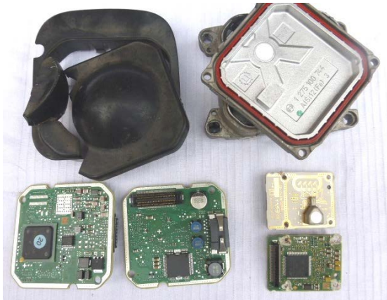
Abbildung 38: Nahdistanzradar - Obere Mittelklasse
