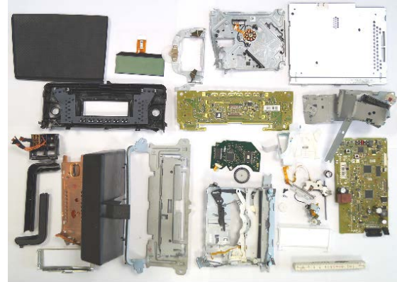
Abbildung 22: Navigationsgerät - Mini Van
