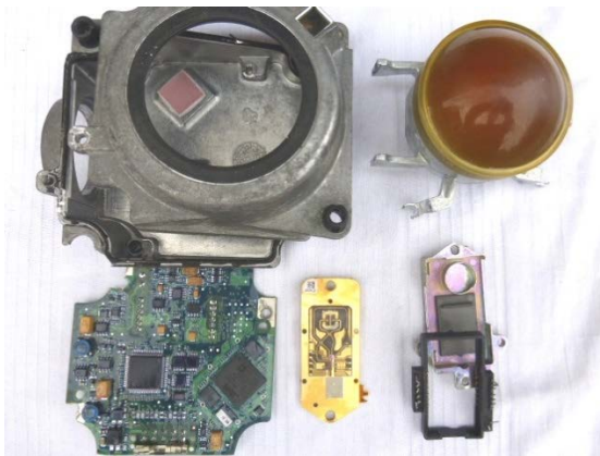
Abbildung 38: Nahdistanzradar - Obere Mittelklasse
