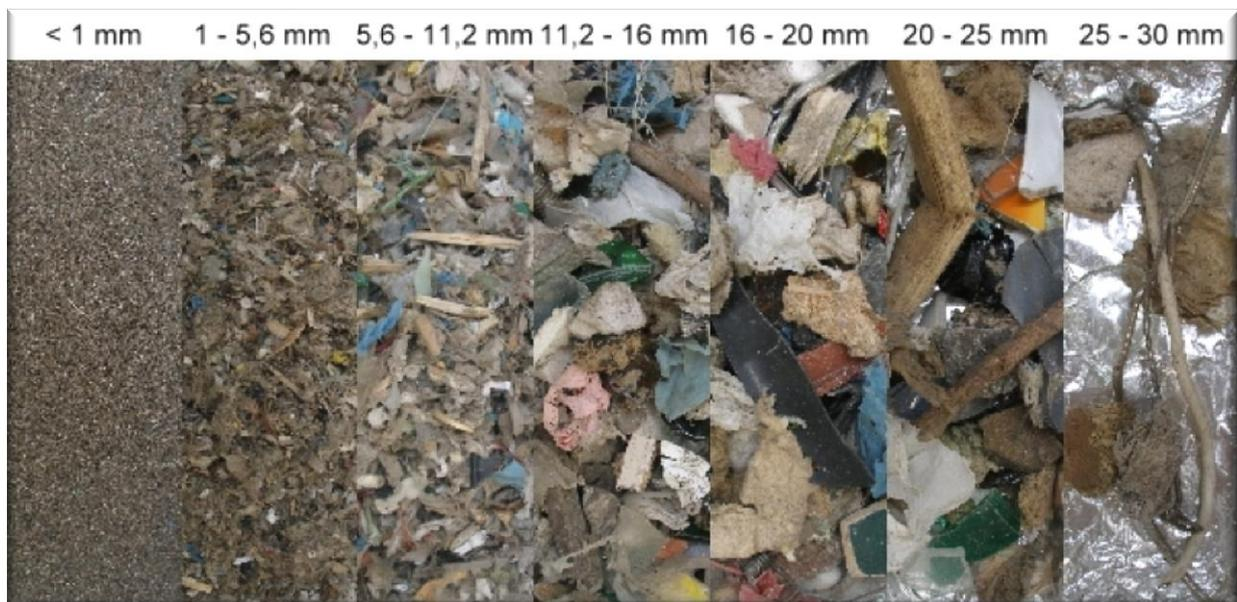
Um zu verdeutlichen, dass gemischte gewerbliche Siedlungsabfälle und gemischte Bau- und Abbruchabfälle zwei unterschiedliche Stoffgemische darstellen, wird zum Vergleich die Siebfractionen einer Feinfraktion von gemischten Bau- und Abbruchabfällen aufgezeigt.
