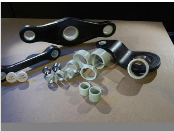
Abb. 31: Kunststoffbuchsen für den Einsatz im Y25 Drehgestell
