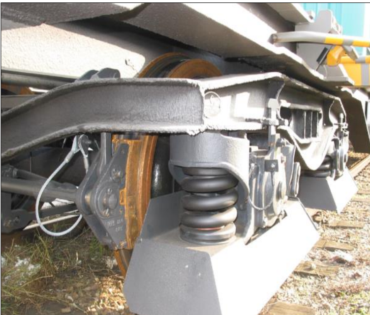
Abb. 27: Schallschürze am Radsatz
