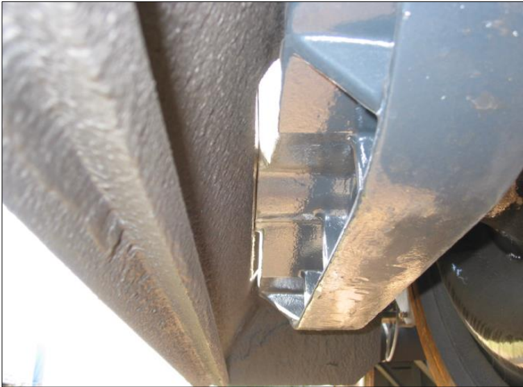
Abb. 28: Schallschürze mit Entdröhnungsmaterial
