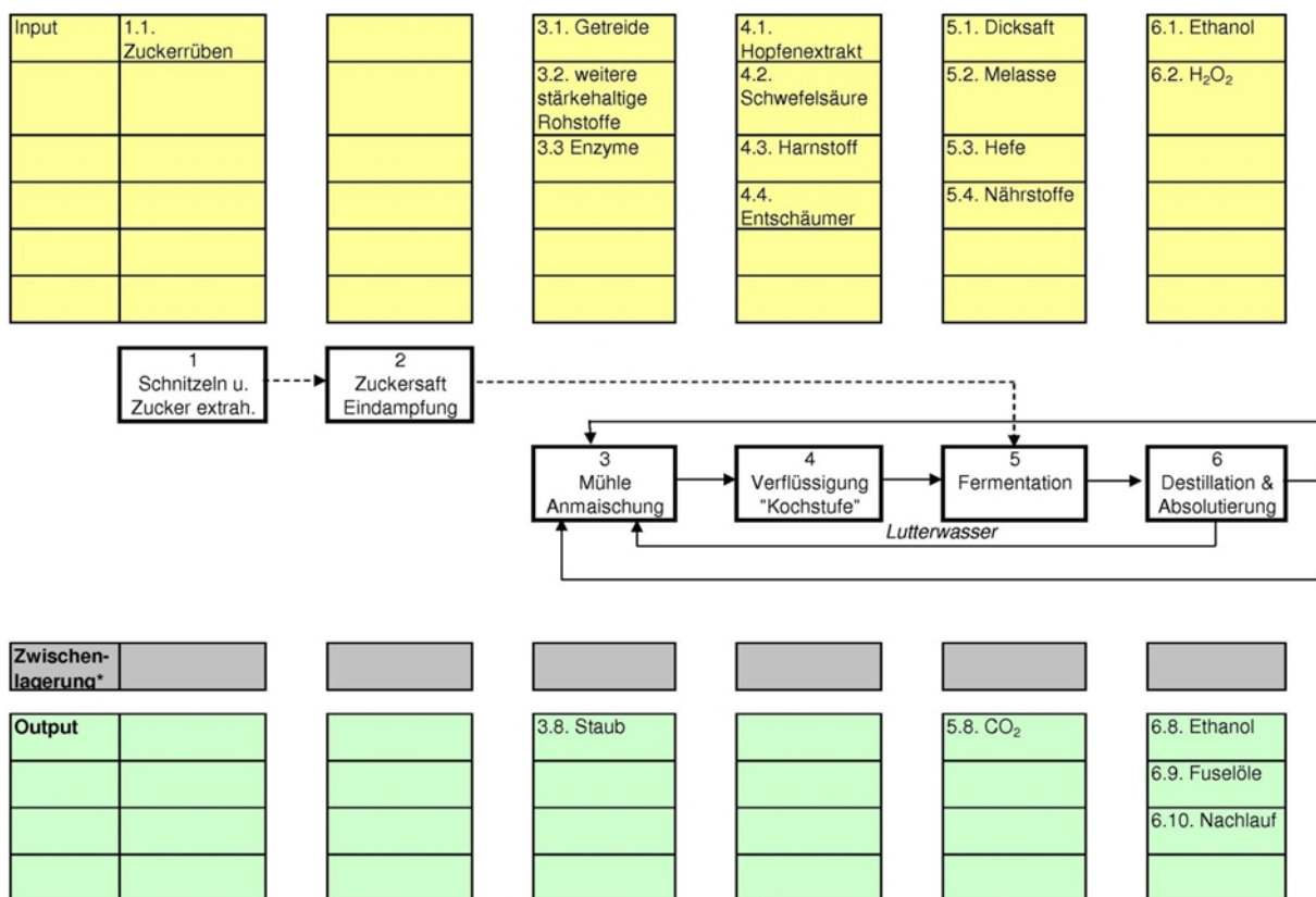
Abbildung 4: Typischer Prozessschritt zur Herstellung von Bioethanol, Teil 1
