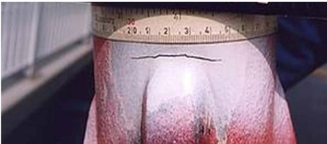
Abbildung 54: Ermüdungsriss nach Regen-Wind induzierten Schwingungen
