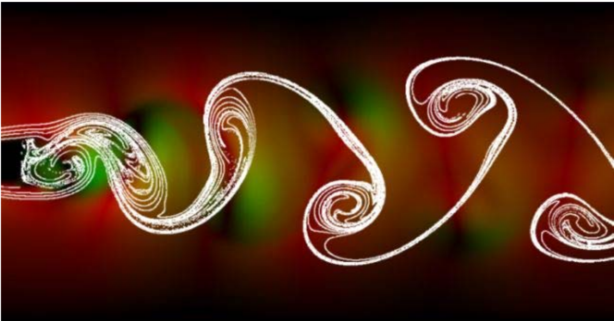
Abbildung 52: Wirbelstraße an einem kantigen Profil
