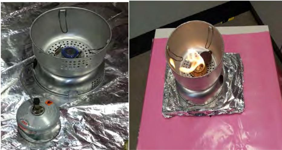
Um eine Einschätzung über die Quellaktivität zu erlangen, wurden die Partikelanzahl- und Massenkonzentration sowie Partikeloberflächenkonzentration erfasst. Die Klimatisierung wurde auf 24 °C und minimale Lüftungs- und Gebläsestufe eingestellt.
