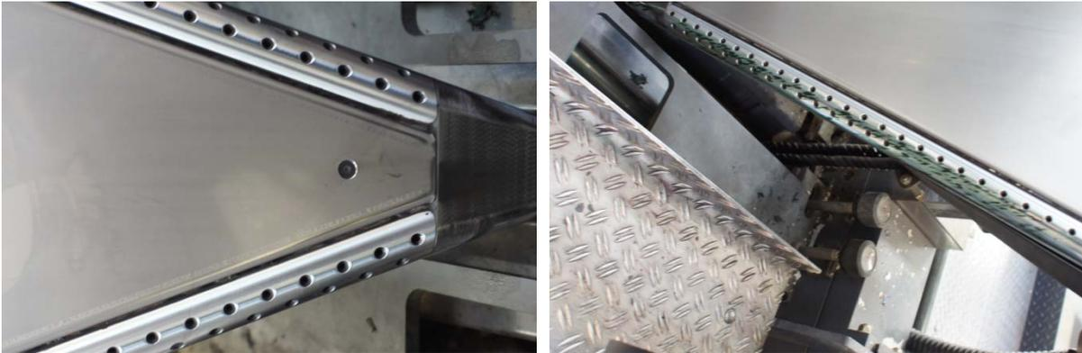
Abb. 8: Rückstände am Falztrichter nach dem Druckvorgang mit dem mineralöhlhaltigen Farbsatz 1.
