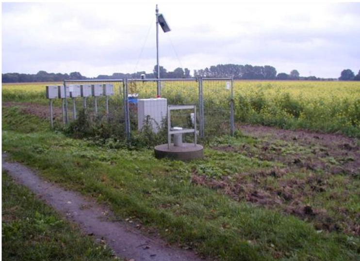
Abbildung 31 zeigt das Schichtenverzeichnis und ein Foto der Grundwassermessstelle des NLWKN an der Boden-Dauerbeobachtungsfläche (BDF) in Dinklage. An diesem Standort wurde seit vielen Jahren die Beschaffenheit des oberflächennahen Grundwassers regelmäßig untersucht und Sonderbeprobungen auf Tierarzneimittel seitens des NLWKN und des LBEG durchgeführt (Höper 2011).
