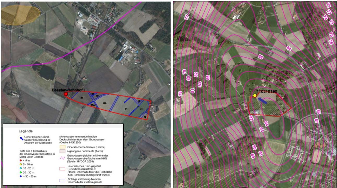
Tiefenlage des Filterausbaus bis zu einem Abstand von 500 m (Filter < 10 m Tiefe) bzw. 1 km Abstand in die Zustromrichtung des Grundwassers zur Messstelle in Form einer Ellipse mit einem festen Öffnungswinkel und einer maximalen Breite der Ellipse von 150 m ausgerichtet (siehe Abbildung 41). Da dem NLWKN die Betriebsdaten zu allen Flächen vorlagen und diese digital übermittelt wurden, war eine Ausrichtung auf bestimmte Schläge nicht notwendig.
