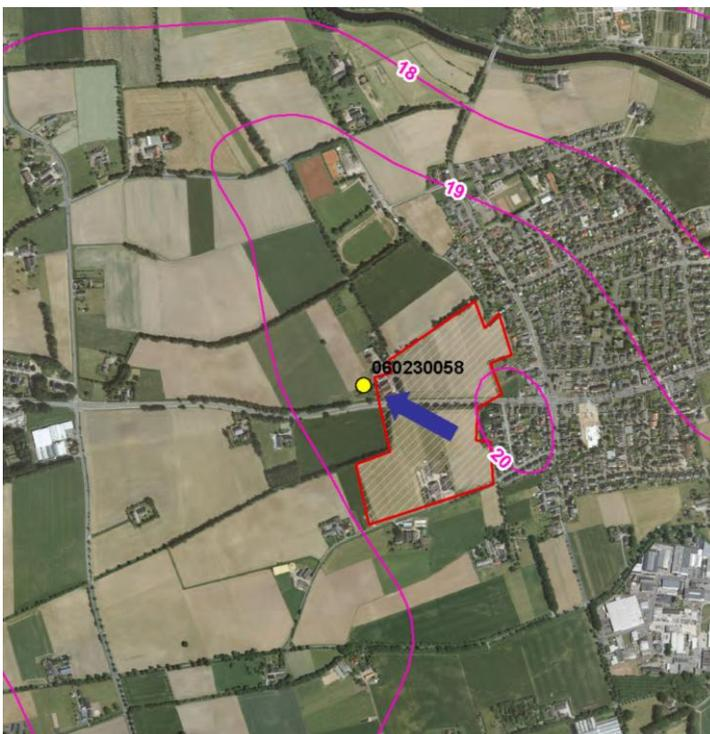
Bei der Messstelle Lowick westlich von Bocholt (s. Abbildung 58) erfolgt der Zustrom von Südosten aus der landwirtschaftlichen Nutzfläche heraus. Der Filterausbau reicht von 2 bis 15 m unter Gelände, durch diese lange Strecke erfolgt eine Unschärfe durch den lateralen Zustrom von Grundwasser in den tieferen Filterabschnitten. Die Nutzflächen wurden nach Angabe der LWK NW in den letzten Jahren primär mit Rinder- und Schweinemastgülle behandelt, untergeordnet kam auch Milchgülle zum Einsatz.
