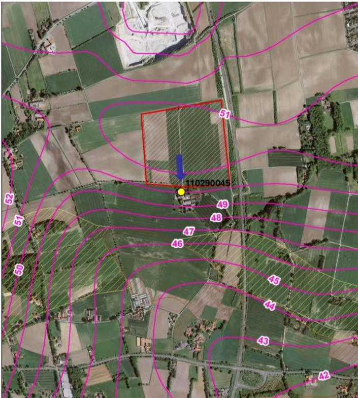
Die Messstelle in Sutrum (1100290045, siehe Abbildung 57) ist oberflächennah von 4,50 bis 9,50 m Tiefe in einem von Sanden überlagerndem Kalkstein ausgebaut. Das ist der bisher einzige nachgewiesene TAM-Fund in Deutschland in einem Festgesteins-Grundwasserleiter. Der Zutritt erfolgt hier vorwiegend über Klüfte.
