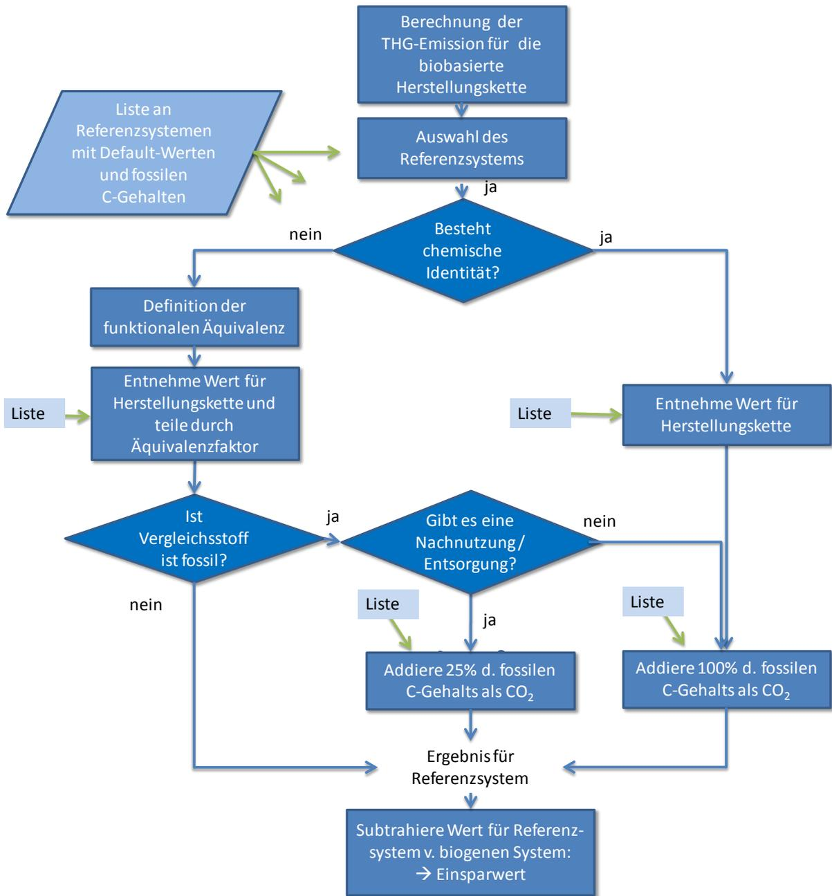
Abbildung 55: Ablaufschema für die Auswahl und Berechnung der Treibhausgasemissionen des Referenzsystems einer stofflichen Biomassenutzung zur übersichtsartigen Ermittlung (Screening) des (Netto-) Treibhausgaseinsparwerts (IFEU 2013)
