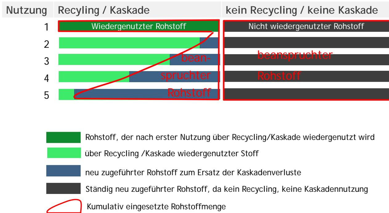
Abbildung 30: Schematische Darstellung des kumulativen Rohstoffverbrauchs bei wiedergenutztem und nicht wiedergenutztem Rohstoff. (IFEU 2013)
