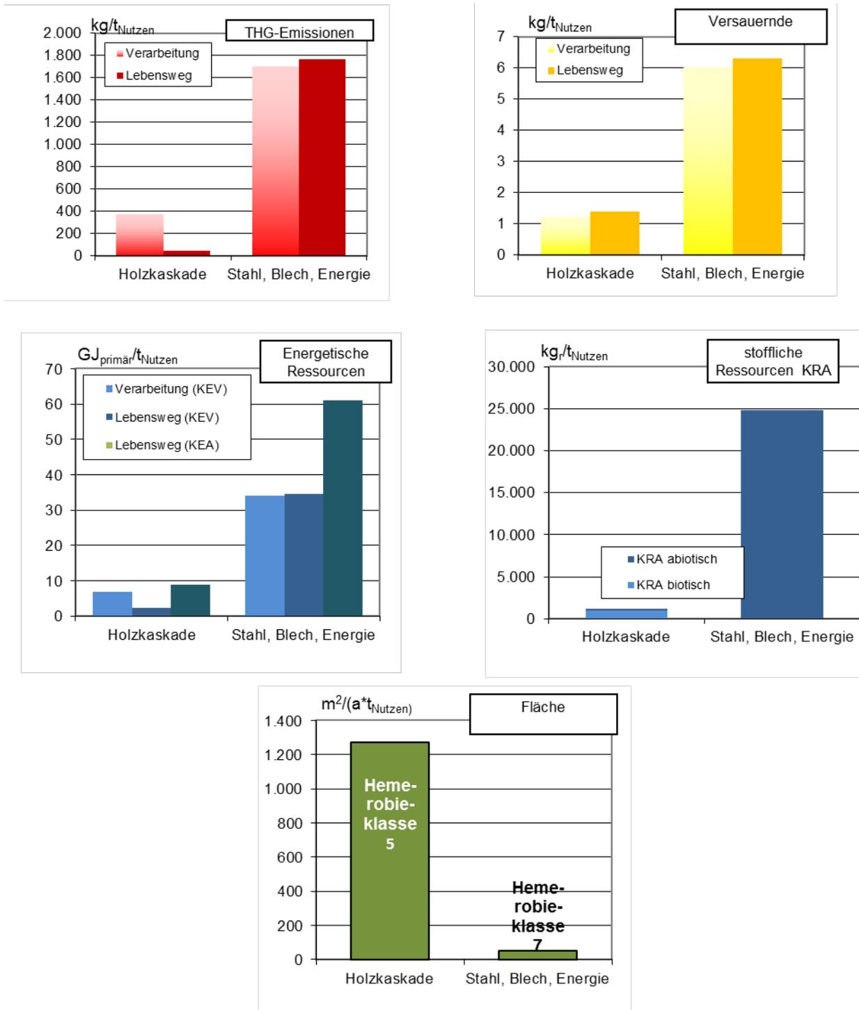
Abbildung 37: Ergebnisse der Indikatoren für das Substitutionspaar Holzskade/ Stahl-Blech-Energie (IFEU 2013)
