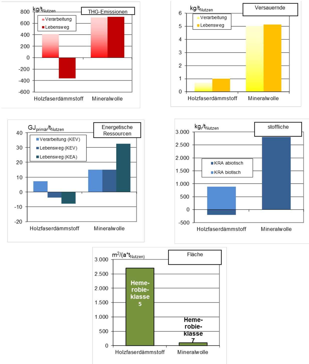
Abbildung 35: Ergebnisse der Indikatoren für das Substitutionspaar Holzfaserdämmstoff/Mineralwolle (IFEU 2013)
