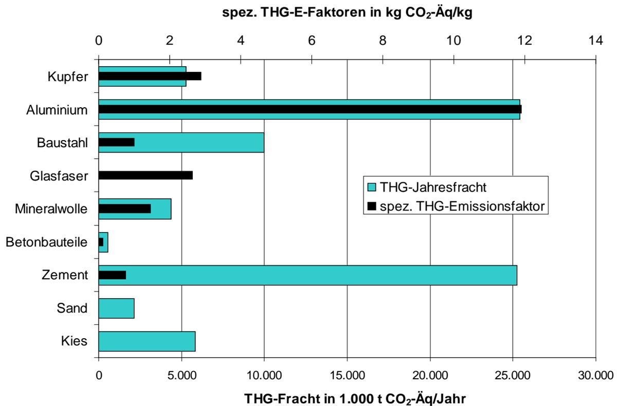
Abbildung 27: Spezifische THG-Emissionsfaktoren (Quelle: Ecoinvent) und damit errechnete Jahresfrachten der Herstellung von mineralischen Erzeugnissen und Metallen. (IFEU 2013)
