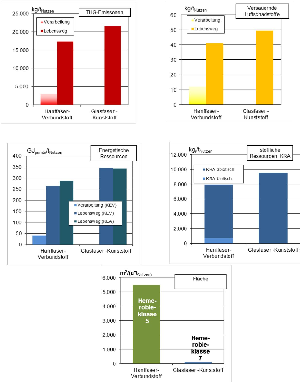
Abbildung 36: Ergebnisse der Indikatoren für das Substitutionspaar Hanffaserverbund/Glasfaserverbund (IFEU 2013)
