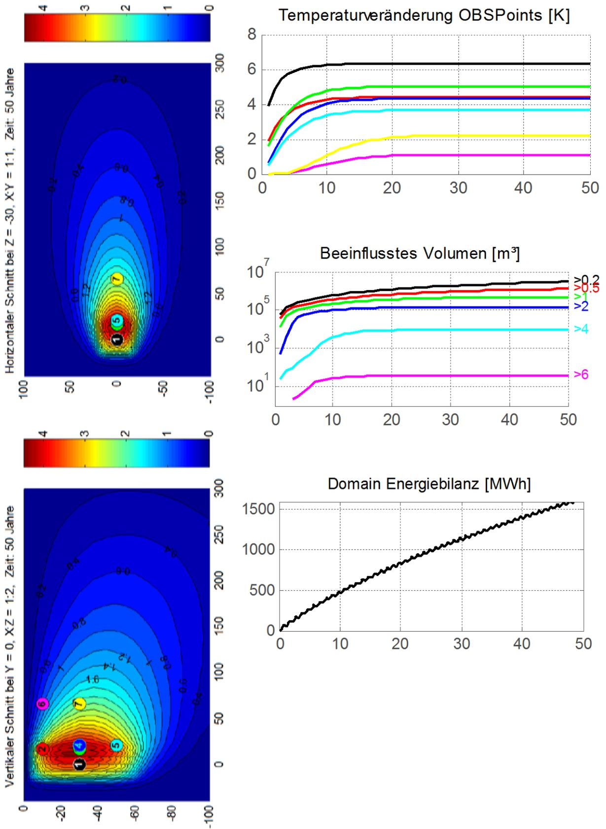
Thermische Prognose - Referenzszenario LC\_VFE6 (Erdwärmesonden)
