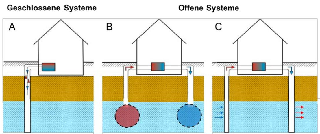
Abbildung 1: Schematische Darstellung der verschiedenen Typen von Geothermieranlagen. A - Erdwärmesonde; B - Wärme- und Kältespeicher; C - offene Brunnenanlage im hochdurchlässigen Aquifer.
