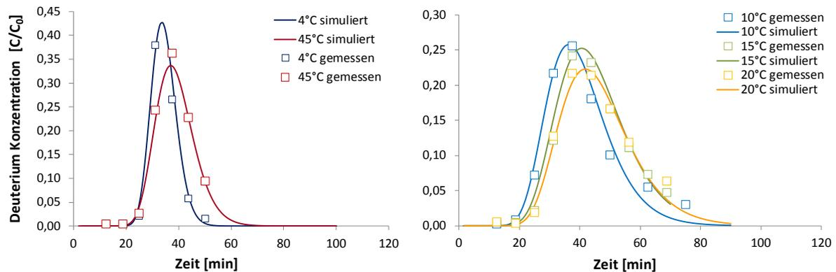
Abbildung 25: Vergleich des gemessenen Verlaufes mit dem berechneten Verlauf der Tracer-Durchbruchskurven bei den verschiedenen Versuchstemperaturen an ausgewählten Beispielssäulen.
