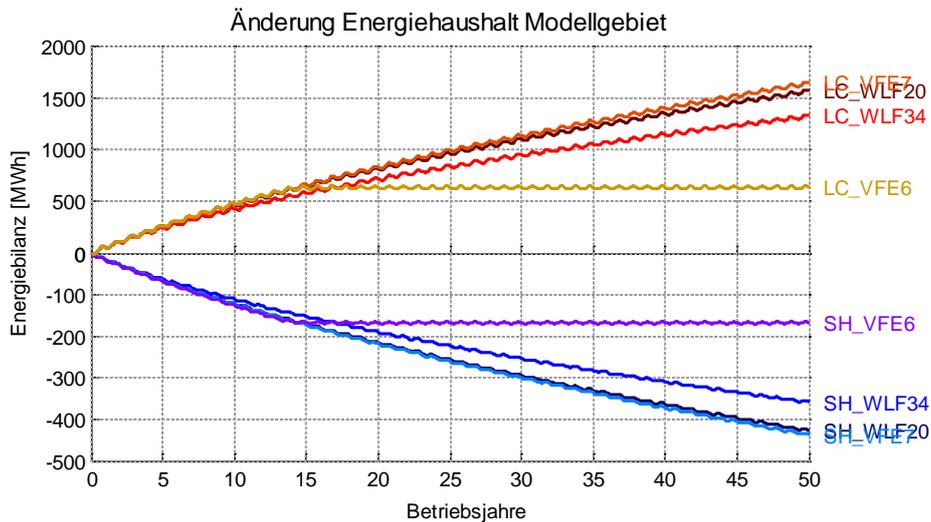
Abbildung 13: Szenarienvergleich - Gesamtenergiehaushalt (Hinweis: positiver und negativer Teil der Bilanzachse sind unterschiedlich skaliert!)
