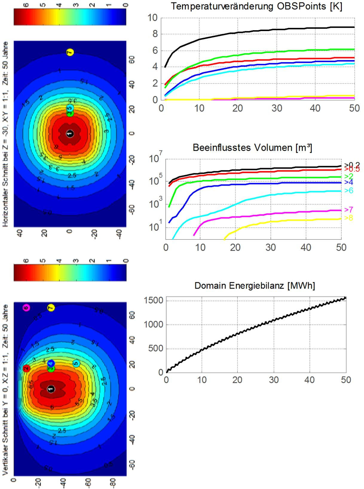
Thermische Prognose - Referenzszenario LC\_WLF34 (Erdwärmesonden)
