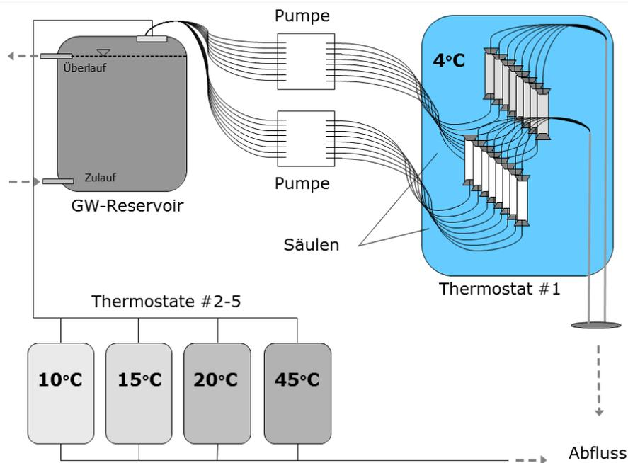
Abbildung 4: Beispielhafter Aufbau eines Säulenversuchs
