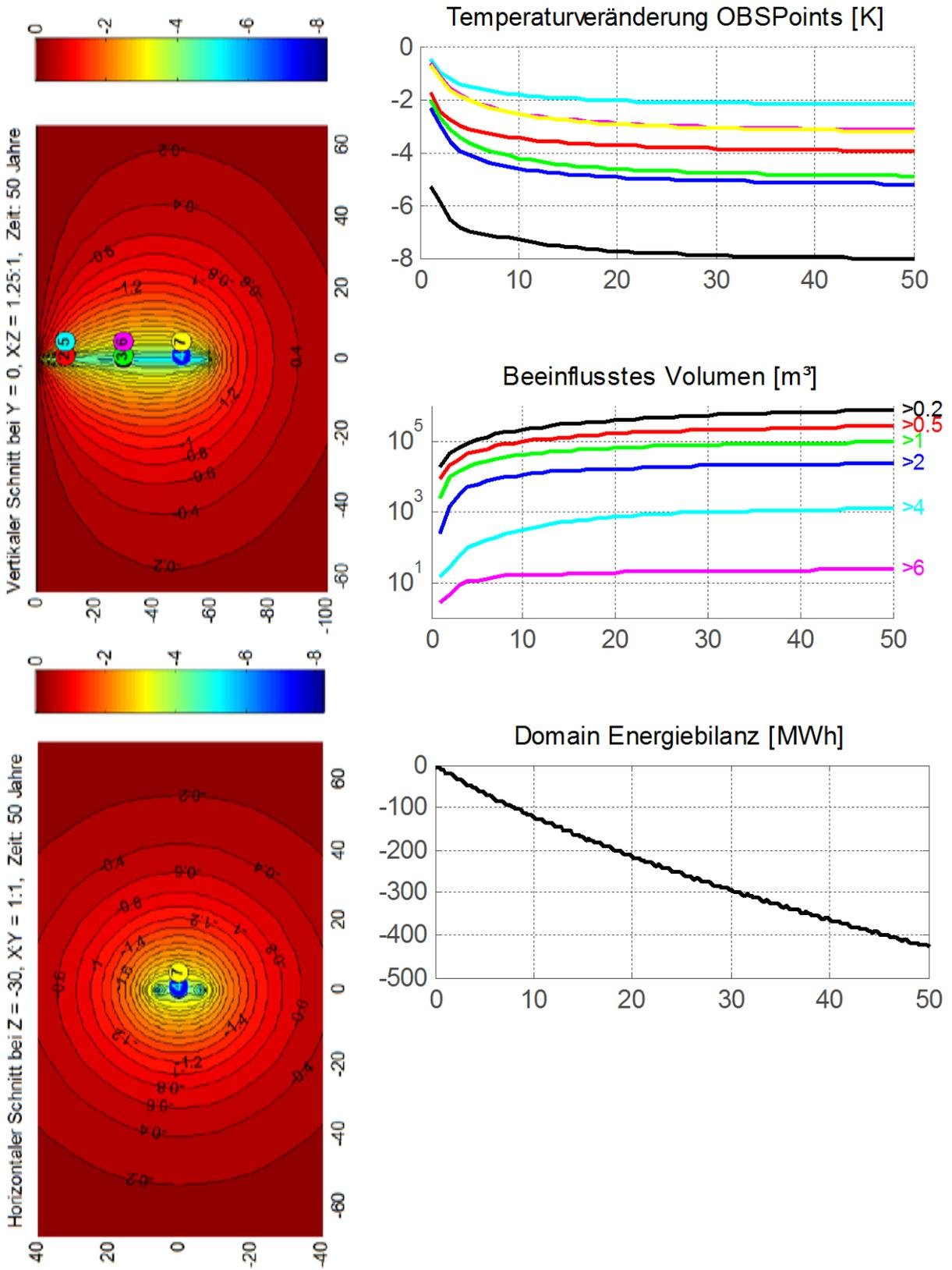
Thermische Prognose - Referenzscenario SH\_WLF34 (Erdwärmesonden)
