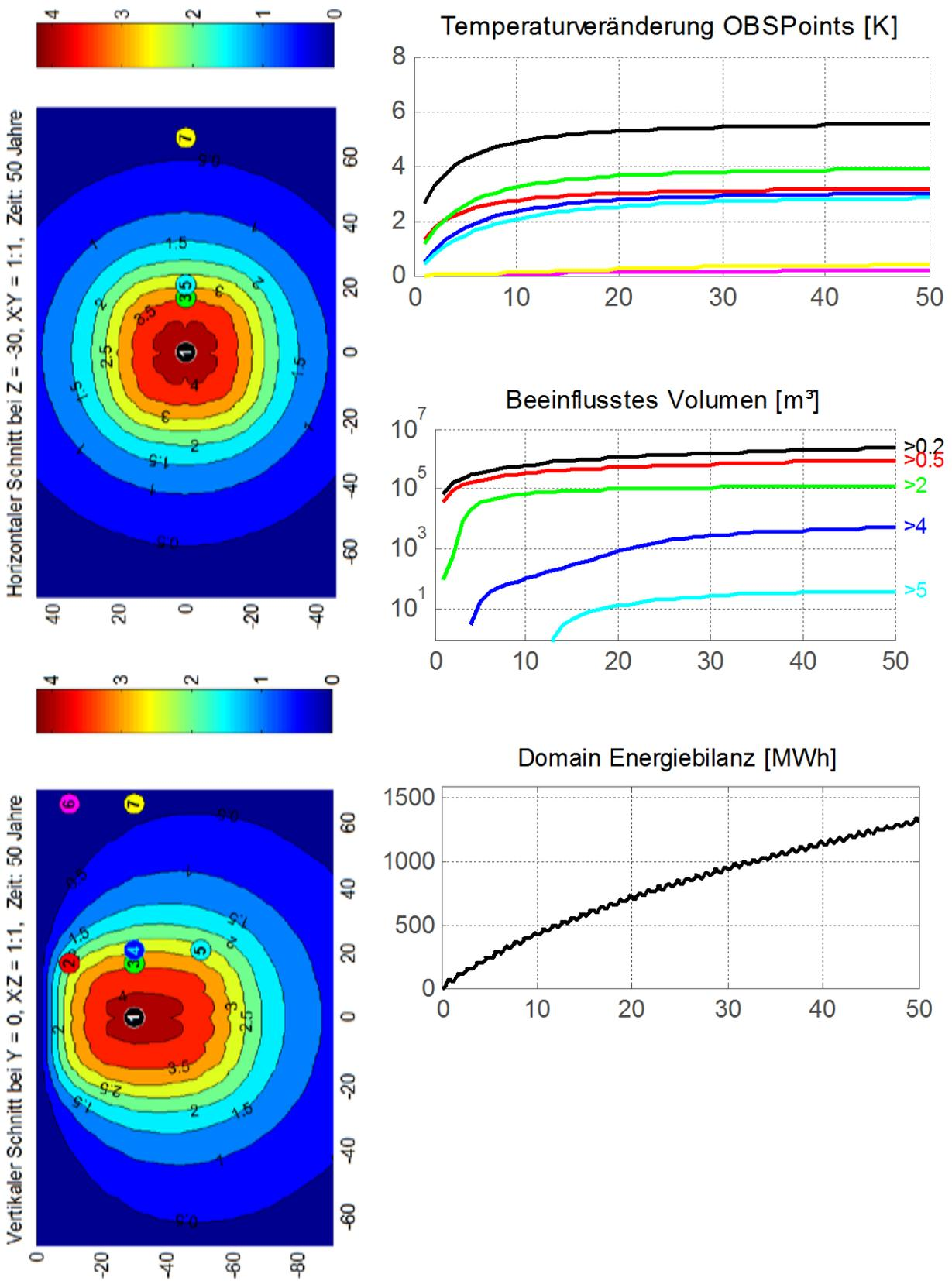
Thermische Prognose - Referenzszenario LC\_VFE7 (Erdwärmesonden)
