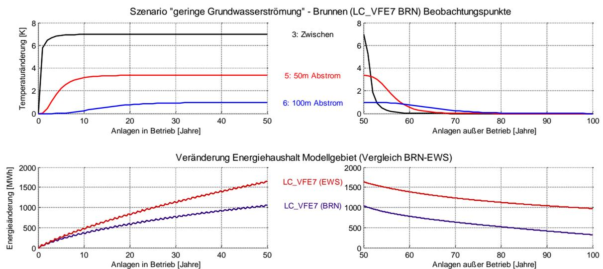
Abbildung 21: Temperaturentwicklung an Beobachtungspunkten im Szenario LC\_VFE7 BRN (oben) und Vergleich der Entwicklung des Energiehaushaltes in 50 Jahren Betrieb und 50 Jahren Regeneration zwischen offenen und geschlossenen Systemen anhand des Referenzszenarios LC\_VFE7 (unten)
