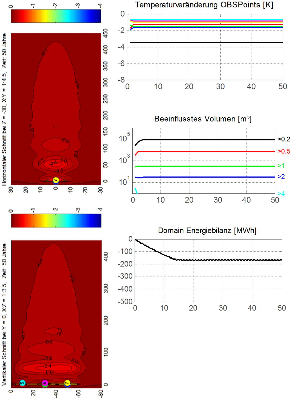
Thermische Prognose - Referenzscenario LC\_WLF20 (Erdwärmesonden)
