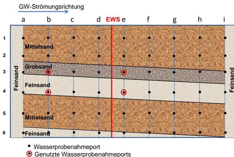
Abbildung 6: Seitenansicht VEGAS-Versuchsbehälter, Längstransect C (siehe Abbildung 5)
