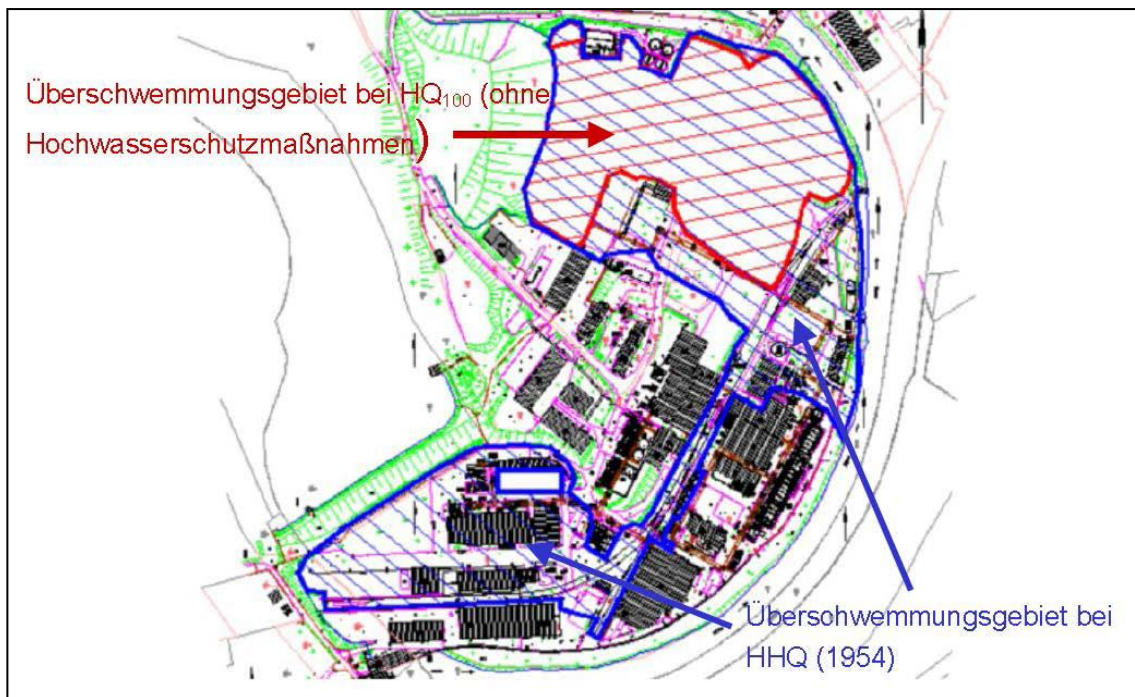
Anhang 6, Abb. 8: Überflutetes Werksgelände bei HHQ
