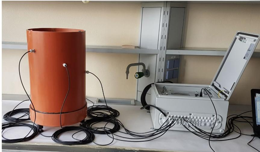
Abbildung 2: Säule mit spiralförmig angeordneten Feuchtigkeitssensoren und Datenlogger
