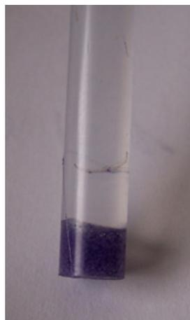
Abb. 5 Foto eines verschlossenen PVC-Rohres (Vorversuches), welches mit transparentem, festem Agar-Agar gefüllt ist.
