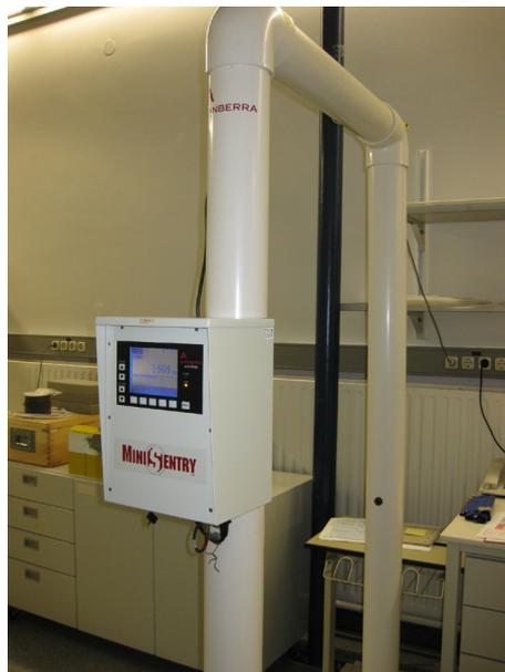
Abb. 11 Foto des transportablen Gamma-sensitiven Portal-Monitors MiniSentry mit Bedien- und Anzeigeeinheit.
