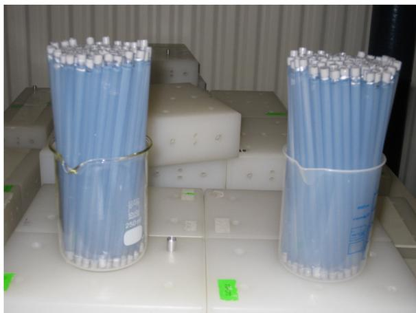
Abb. 6 Foto mit  $^{197}\text{Hg}$  Stabquellen in zwei Bechergläsern.
