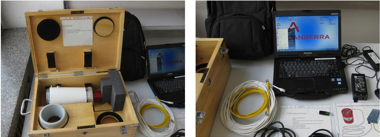
Abb. 10 Fotos der  $\text{LaBr}_3$ -Messsonde mit Zubehör. Links: Koffer mit Messsonde und Abschirmmaterialien; Rechts: Laptop und für den Betrieb des Detektorsystems benötigtes Zubehör.
