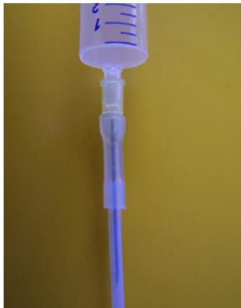
Abb. 4 Foto einer Einwegspritze mit Doppelschlauch, welche zum Einfüllen des mit dem Gamma-strahlenden Material versetzten Agar-Agar in das PVC-Rohr verwendet wurde.
