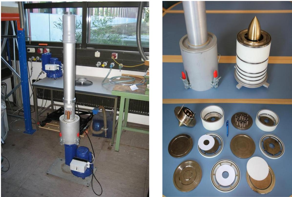
Abb. 6: Gesamtansicht des Kaskadenimpaktors und Ansicht im zerlegten Zustand. Der Back-up-Filter (rechts unten) wird von einer Messingfritte getragen.
