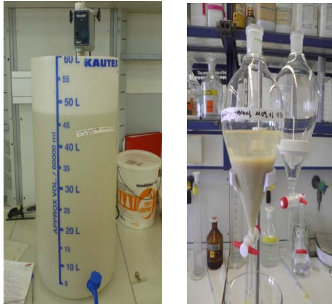
Abb. 1: Links: 50 l Flusswasserprobe in 60 l Fass Rechts: Niederschlag aus Bentonitfällung im Scheidetrichter
