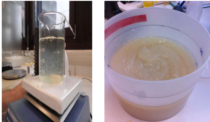
Abb. 2: Links: Flockenbildung nach Zugabe von Fe(III)-Lösung Rechts: Niederschlag nach Eisenfällung mit Tapetenkleister verrührt im Marinellibecher
