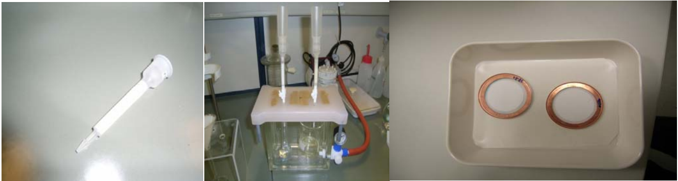
Abbildung 1: links: Sr-Resin®-Säule, Mitte: Einsatz einer Vakuumbbox bei der Trennung, rechts: SrCO 3 -Präparat
