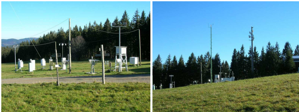
Abbildung 3.6: Die Station Schauinsland des Umweltbundesamts. Links ist der Messgarten zu sehen, rechts aus etwas größerer Entfernung der 10-m-Windmast im Vordergrund und der 20-m-Mast im Hintergrund, und am Bildrand das Stationsgebäude. Blick nach Südosten.
