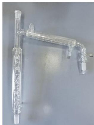
**Abb. 1:** Teil einer Mikro-Schliff-Destillationseinheit – Vigreux-Kolonne und Liebigkühler
