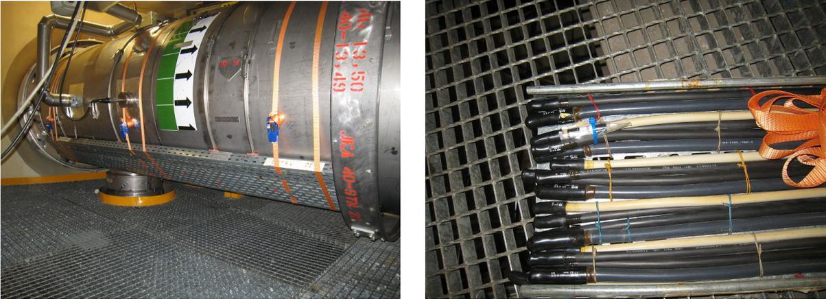
**Abbildung 3-2 Kabelprobendeponie an Loopleitung eines DWR (links); Kabelproben im Detail (rechts)**
