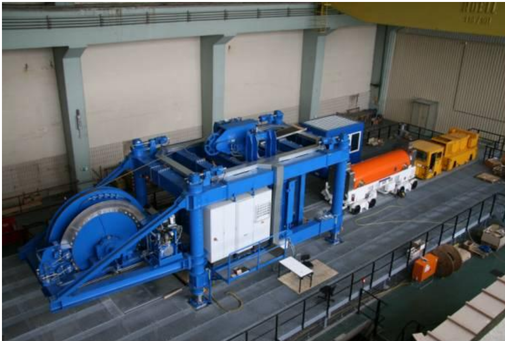
Abbildung D-7 : Versuchsstand zur Weiterentwicklung der Bohrlochlagertechnik
