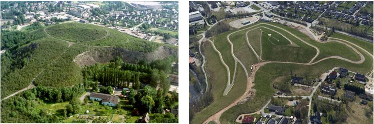
Abb. 1: Sanierung der Halde 66/207 (Standort Schlema, Bereich Edelfhofweg) vor und nach der Sanierung
