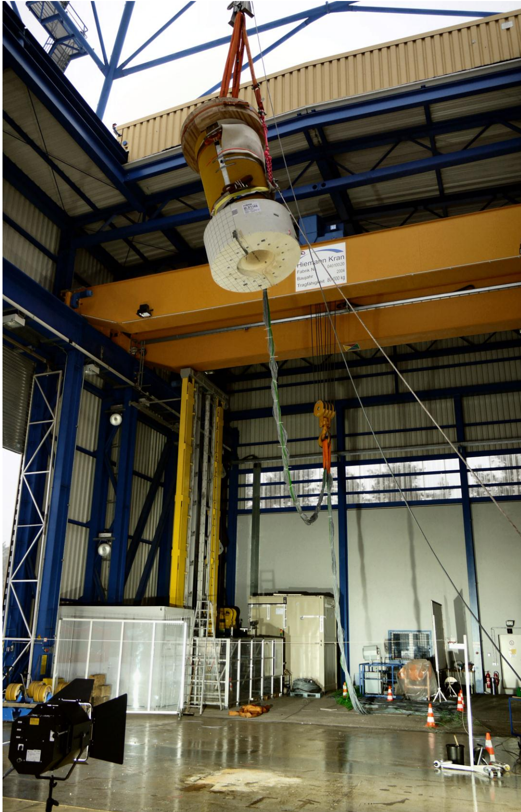
Abbildung G-1: Fallversuch eines Transport- und Lagerbehälters für verglaste Abfälle im Versuchsstand der Bundesanstalt für Materialforschung und -prüfung (BAM) im Rahmen eines verkehrsrechtlichen Zulassungsverfahrens (Bildrechte: BAM)
