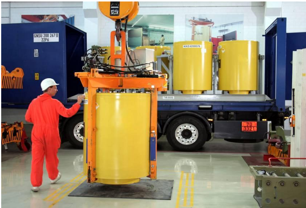
Abbildung F-3: Wischtest zur Produktkontrolle an einem MOSAIK-Behälter (Bildrechte: GNS)
