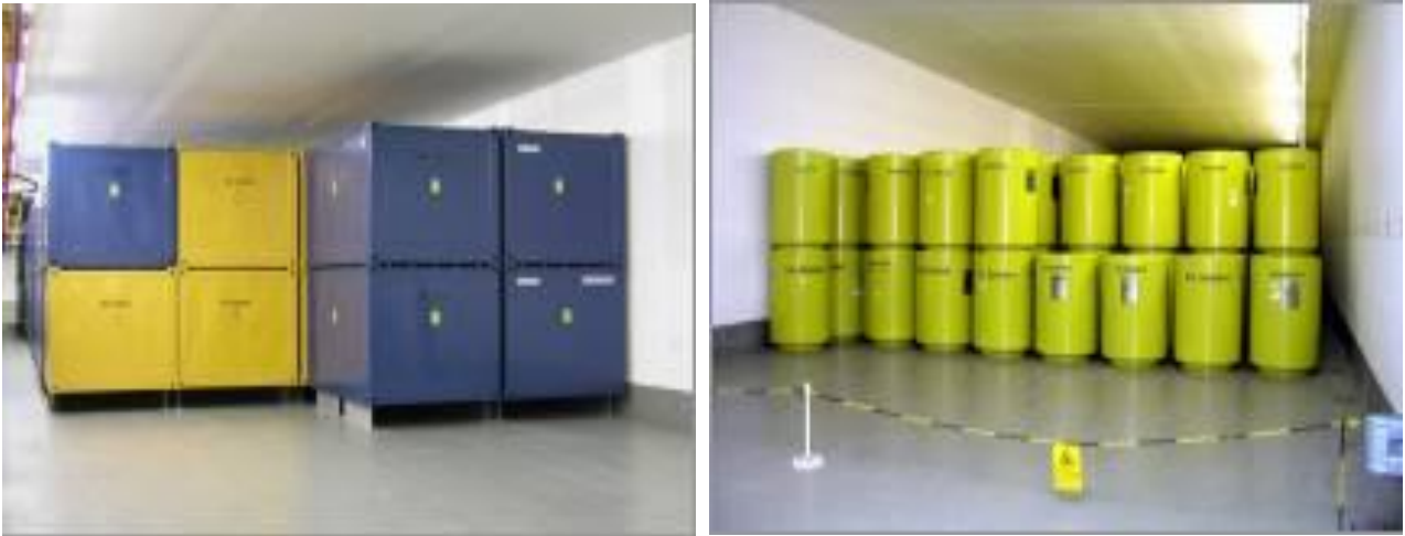
Abbildung D-11: Beispiele für standardisierte Abfallbehälter (links Konrad-Container, rechts Gussbehälter) (Bildrechte: GNS)
