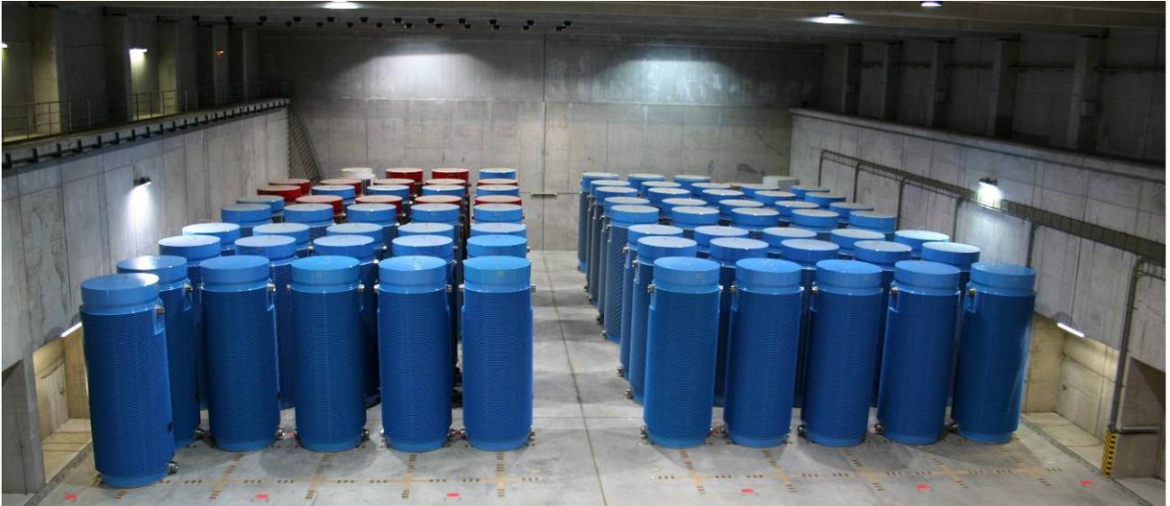
Abbildung D-3: CASTOR® THTR/AVR und CASTOR® MTR im Transportbehälterlager Ahaus (Bildrechte: GNS)
