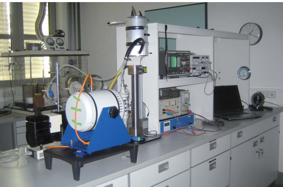
Abbildung 13: Shaker (Rüttler), mit dem die Freisetzung von Nanomaterialien bei mechanischer Beanspruchung getestet wird.
