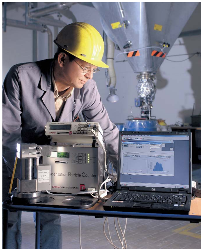
Abbildung 12: Messung von Nanopartikeln mit Hilfe SMPS (Scanning Mobility Particle Sizer)
