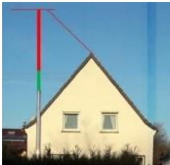
Bild 2: Dachneigung 45°, Abstand zum First: ca. 2 Meter, Schornsteinhöhe über Dach: ca. 4,5 Meter (nicht möglich ohne Tragmast oder zusätzliche Abspannung)
