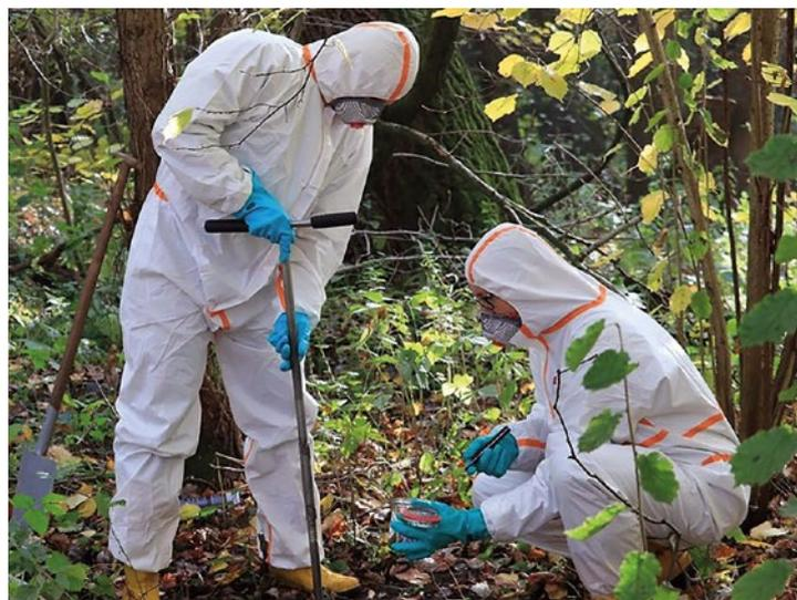
Probenahme bei einer Altlastenverdachtsfläche
